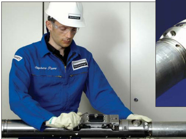
^ Herramienta de medición de presión operada con cable. El diámetro y el perfil de la herramienta PressureXpress están diseñados para reducir el riesgo de atascamiento. Aquí se muestra el sistema de sello de muestreo (negro) y los pistones de anclaje de seguridad (imagen superior – lado inferior) utilizados para empujar y mantener la herramienta en su posición frente a la formación.
